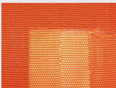
Sección cruzada de una funda DT para eslinga redonda
